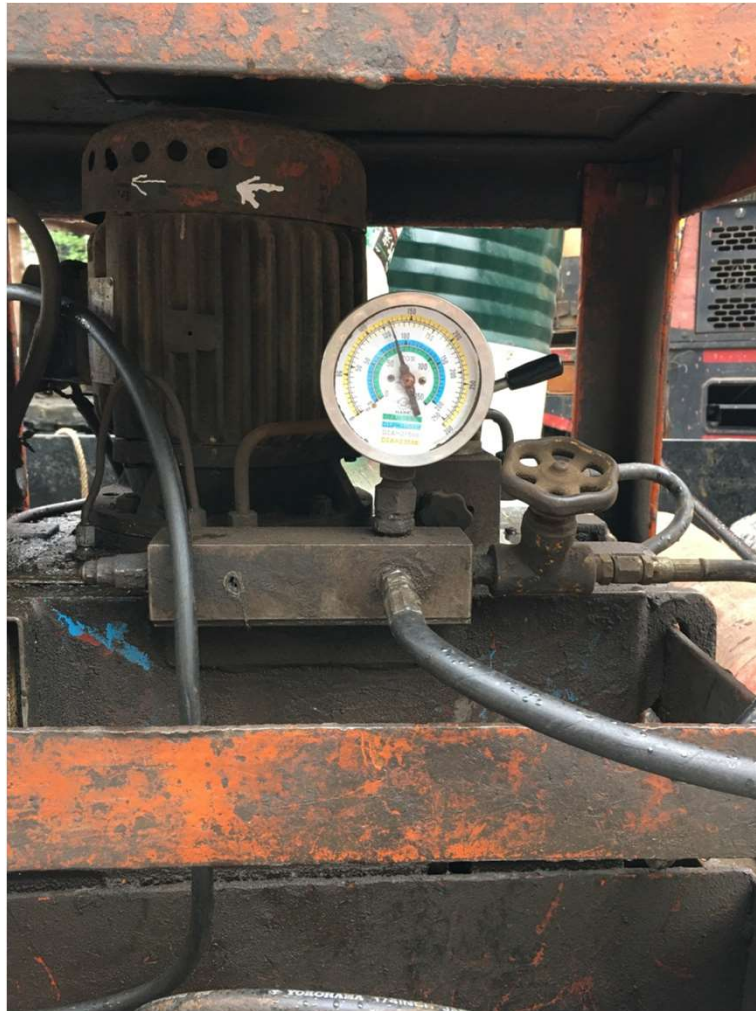
油壓機及土壓計(安裝完,油壓機加壓千斤頂,土 壓計顯示 千斤頂壓力)(第三層支撐壓力100T/支)
