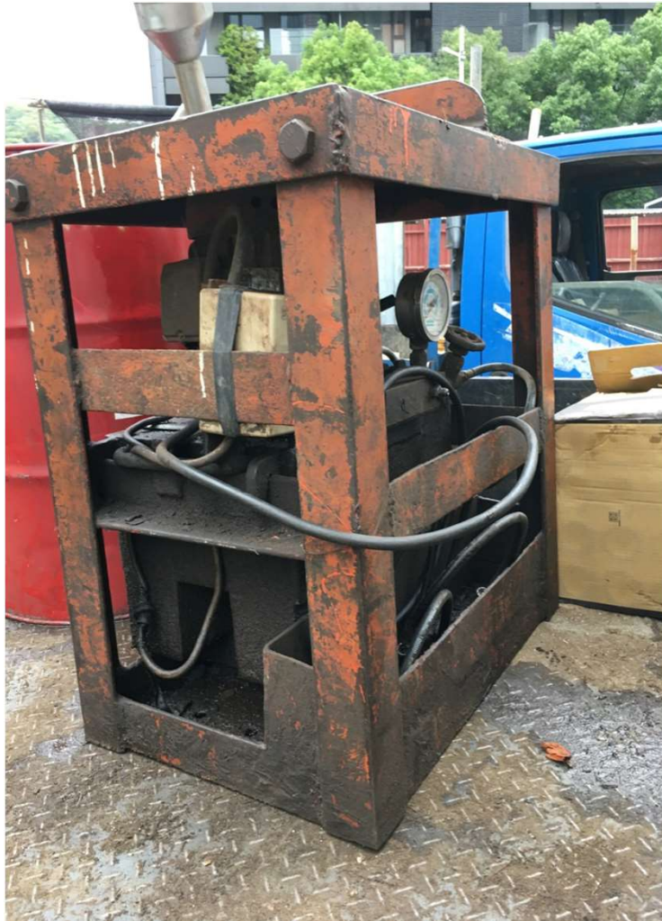
油壓機及土壓計(安裝完,油壓機加壓千斤頂,土壓計顯示千斤頂壓力)
