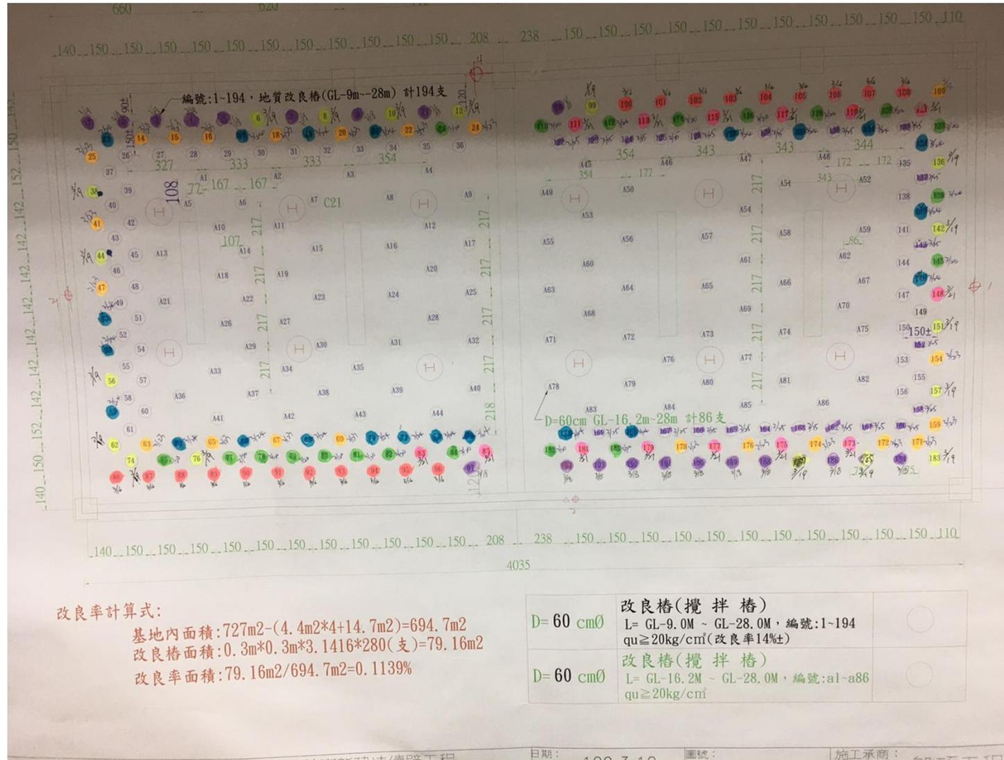
基地內改良樁施工圖(施工順序及完成記錄)
